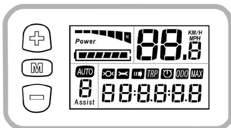
Krátkým stisknutím tlačítka **M** (vlevo, uprostřed) **zapnete** napájení motoru elektrokola. Dlouhým stisknutím tlačítka **M** (vlevo, uprostřed) **vypnete** napájení motoru elektrokola.
