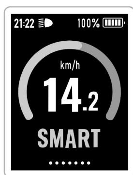
Dlouhým stisknutím tlačítka (na ovládacím panelu vpravo) **zapněte** napájení motoru elektrokola.
